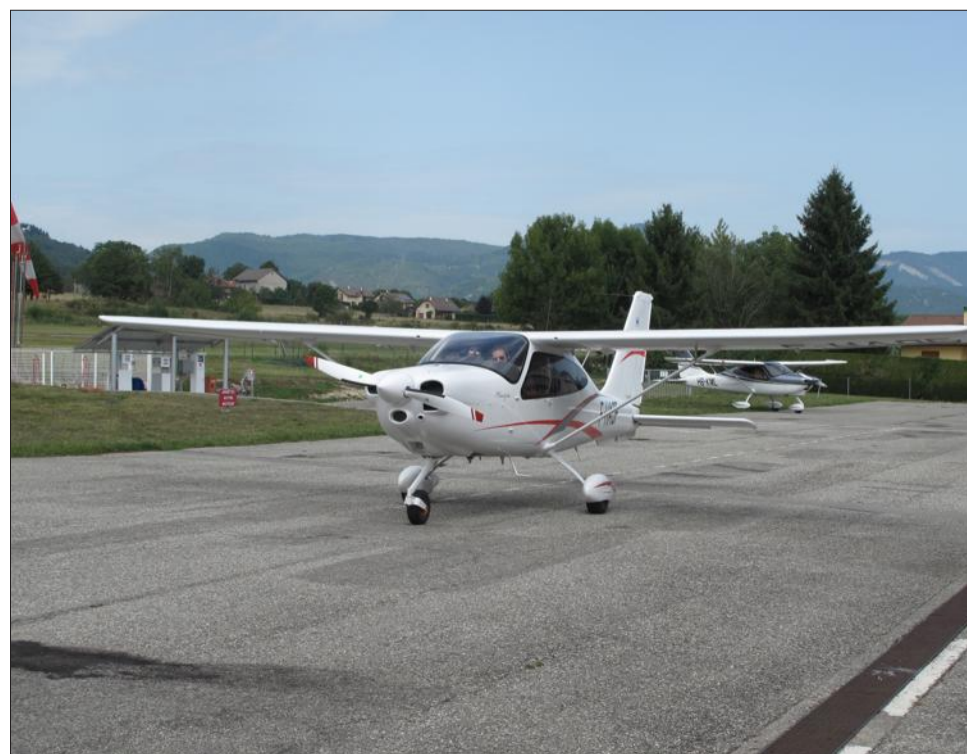
Pour reconnaître un petit avion (2 ou 4 places) d'un ULM (2 places), c'est simple : lorsque le nom de l'avion (son numéro) est sur le fuselage, il s'agit d'un avion. L'identification se trouve sous l'aile sur les ULM, qui ne peuvent voler que de jour. Sur cette photo, c'est donc un avion.
